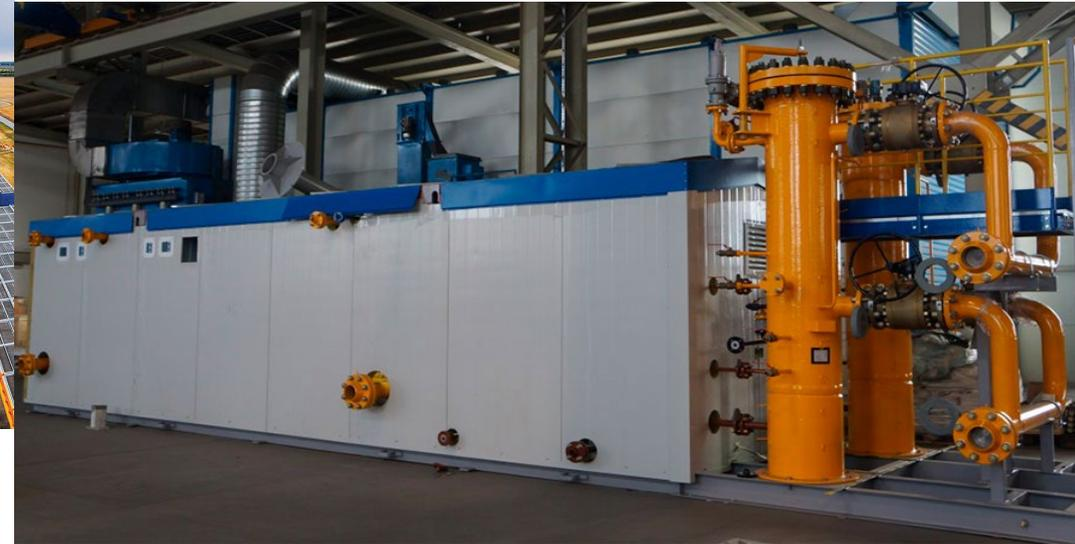
*При компрессорном газлифте комплекс оборудования для эксплуатации группы скважин значительно сложнее, чем при фонтанной эксплуатации, и состоит из компрессорной станции, газораспределительной и газосборной сети, систем подготовки газа и газлифтного оборудования скважин.*
